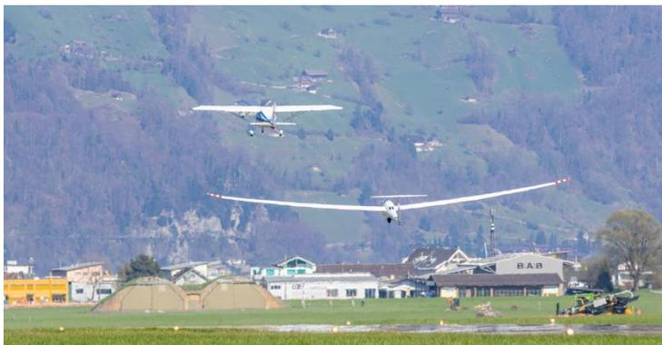
Der Anrollschub sowie die Steigleistungen waren hervorragend und erfüllten die Erwartungen. Zur Zeit laufen die detaillierten Auswertungen der ersten Versuche mit Roll- und Startstrecken sowie den Steigleistungen bei vollbeladenem AC4. Als nächstes werden wir diese Daten auf Graspisten sowie mit unterschiedlichen Schlepphöhen erfliegen.
